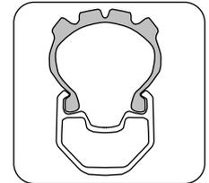
Schlauchlose Bereifung darf nur ohne Werkzeug montiert und von der Felge entfernt werden, andernfalls können in der Folge Undichtigkeiten auftreten. Falls die Dichtflüssigkeit nicht ausreicht, um einen Defekt zu verhindern, kann, nach Entfernen des Ventils, ein normaler Schlauch eingesetzt werden.
